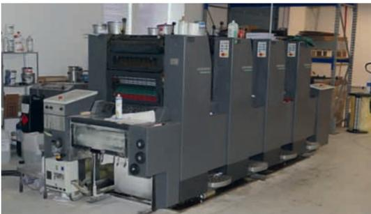
**Eine Vierfarben-Offsetdruckmaschine Heidelberg Speedmaster druckt bei Meier die höheren Auflagen.**
